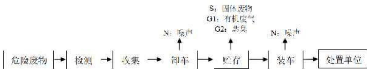
图 3.1-3 危险废物收集转运工艺流程及产污环节
